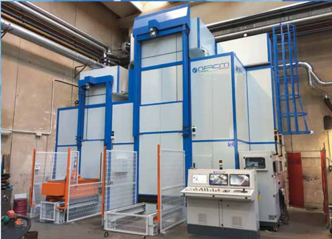
Plant for pressing and welding linear actuators Impianti per la pressatura e saldatura di attuatori lineari
